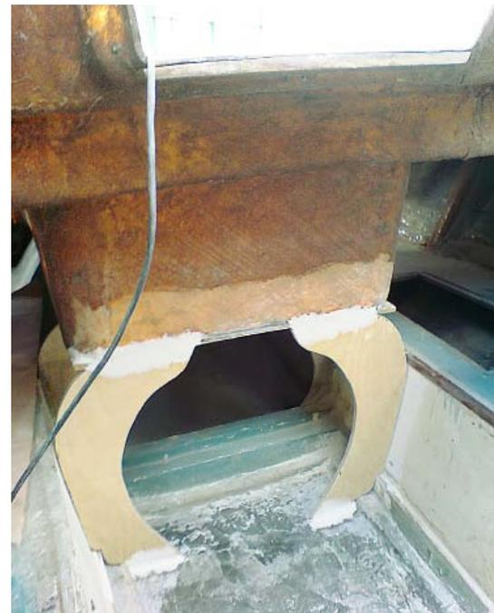
Усиление кокпита с помощью установки дополнительных опор
