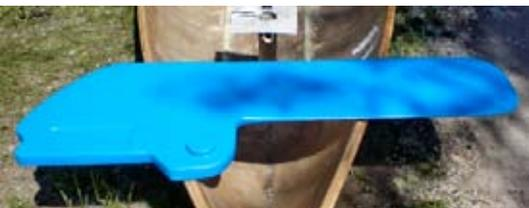
Заводской деревянный шверт отчищаем от краски, шлифуем, покрываем полиэфирной смолой, затем — необрастайкой
