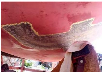
Разделанное углубление для качественной заделки трещины
