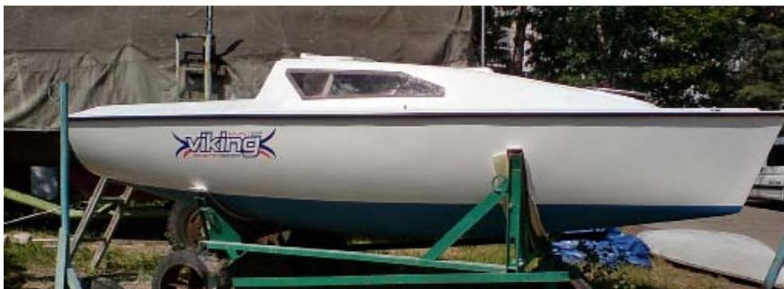
Готовая покрашенная гелькоутом, отшлифованная и отполированная яхта
